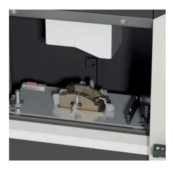
La saldatura simultanea, combinata con la tecnologia di servoazionamento del tavolo di sollevamento di Branson GLX, assicura un ciclo di saldatura ad alta velocità che generalmente va da 0,5 a 5 secondi, a seconda del materiale e della complessità geometrica del componente.
