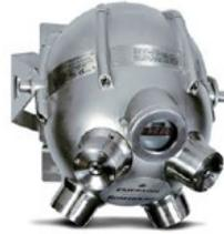
Le système avancé de détection par ultrasons des fuites de gaz Incus d'Emerson utilise quatre capteurs acoustiques ultrasensibles, qui contrôlent en permanence de larges zones à la recherche des ultrasons générés par les fuites de gaz sous pression. Il est parfaitement adapté à la surveillance d'environnements extérieurs bien ventilés tels que les stations-service.
