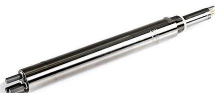
Датчики сопротивления линейной поляризации (LPR-датчики) Roxar извлекаемого типа
