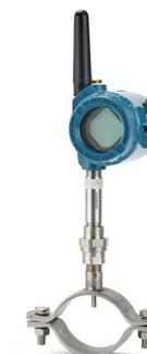
A Tecnologia Rosemount X-well fornece dados precisos da temperatura do processo sem exigir a penetração em tubulação do processo. Ela mede as temperaturas do ambiente e dos tubos para calcular a temperatura do processo com um algoritmo de condutividade térmica. A X-well oferece fácil instalação, com um conjunto de materiais e braçadeiras de tamanhos diferentes, fornecendo uma solução eficaz para uma grande variedade de temperaturas.
