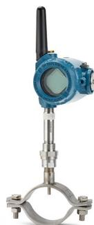
A Tecnologia Rosemount X-well fornece dados precisos da temperatura do processo sem exigir a penetração em tubulação do processo. Ela mede as temperaturas do ambiente e dos tubos para calcular a temperatura do processo com um algoritmo de condutividade térmica. A X-well oferece fácil instalação, com um conjunto de materiais e braçadeiras de tamanhos diferentes, fornecendo uma solução eficaz para uma grande variedade de temperaturas.
