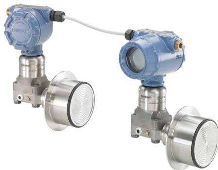
Com o melhor desempenho da classe e estabilidade de medição, o Sistema ERS calcula a pressão diferencial eletronicamente usando dois sensores de pressão conectados por um cabo elétrico. Fácil de instalar, esse sistema foi projetado para oferecer um tempo de resposta mais rápido em comparação com sistemas tradicionais para proporcionar desempenho excepcional.
