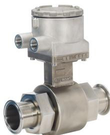
Um medidor de vazão com um corpo totalmente soldado que foi projetado para aplicações de processamento de laticínios que demandam desempenho seguro, higiênico e confiável. Todas as superfícies de contato são construídas com materiais aprovados pela FDA, projetadas de acordo com as normas 3-A e EHEDG. Além disso, o 8721 está disponível com uma variedade de conexões de processo sanitário com gaxetas de processo facilmente acessíveis para facilitar a inspeção e a manutenção eficientes.
