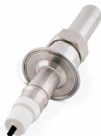
Esse sensor apresenta um eletrodo de pH de transistor de efeito de campo seletivo a íons (ISFET) que fornece medição de pH estável. Sua taxa de resposta pode ser 10 vezes mais rápida do que a de eletrodos de vidro, permitindo melhor controle do processo. Seu tempo de resposta curto e maior estabilidade fornecem intervalos maiores entre a calibração e a manutenção do sensor.
