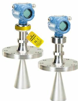
O Transmissor de nível por radar sem contato Rosemount 5408 aprovado pela 3-A usa tecnologia avançada e Design centrado no ser humano para oferecer medições precisas, confiáveis, de materiais líquidos e sólidos. Usando a tecnologia FMCW de dois fios, ele aciona um eco contínuo para maximizar a intensidade de sinal de radar e produzir uma medição mais robusta e confiável.
