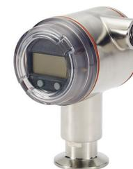
Um transmissor de pressão criado com conexões de processo padrão do setor, esse dispositivo atende às normas do setor 3-A e EHEDG, apresentando um invólucro de aço inoxidável polido. O transmissor oferece o melhor desempenho da classe de 0,065% de span e estabilidade de 5 anos. A tecnologia do sensor oferece excelente repetibilidade em batelada, até 0,02% de limite de faixa superior para 60 bateladas.
