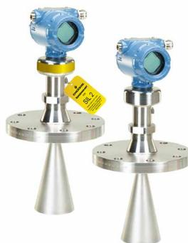
O Transmissor de nível por radar sem contato que é aprovado pela 3-A e usa tecnologia avançada e Design centrado no ser humano para oferecer medições precisas e confiáveis em materiais líquidos e sólidos. Usando a tecnologia FMCW de dois fios, ele aciona um eco contínuo para maximizar a intensidade de sinal de radar e produzir uma medição mais robusta e confiável.
