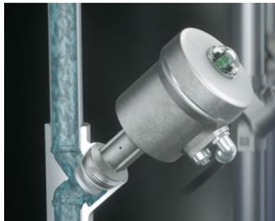
Design "anti-colpo d'ariete" Per le operazioni di chiusura rapida, quando si lavora con i liquidi, la valvola a sede inclinata è dotata di un design "anti-colpo d'ariete" in grado di assorbire picchi di pressione elevati ed evitare danni a tubazioni e attrezzature.
