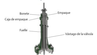
Los bonetes de fuelle de sello ENVIRO-SEAL mejoran la capacidad de sellado de las válvulas Fisher y proporcionan una larga vida útil para aplicaciones en las que no se pueden tolerar las emisiones que se escapan del sello del vástago de la válvula a la atmósfera. Este excelente sistema de sellado del vástago está disponible para las válvulas Fisher easy-e y Fisher GX.
