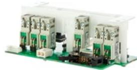
Eine einzigartige Baugruppe regelt den Flüssigkeitsstand in der Blutkammer der Dialysemaschine.
