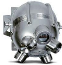
Das moderne Ultraschall-Gasleckererkennungssystem Incus von Emerson benutzt vier hochempfindliche Akustiksensoren, die ständig große Flächen auf Ultraschall überwachen, der durch die Freisetzung von druckbeaufschlagtem Gas erzeugt wird. Ideal geeignet zur Überwachung gut belüfteter Außenumgebungen, wie z. B. die Tankstelle.
