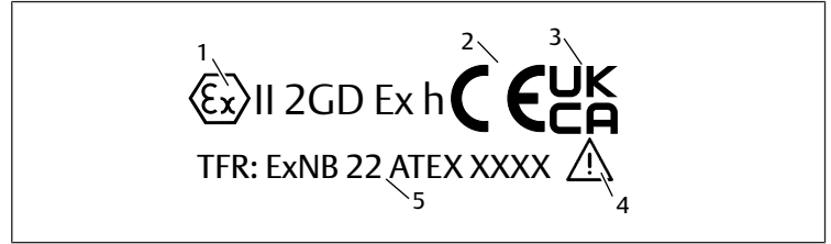
Fig. 3: Targhetta di identificazione per la protezione meccanica contro le esplosioni
