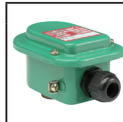
TYPE 04: Métallique, revêtement époxy / Acier inox, AISI 316L WP / WS : CEI 335 EM / WSEM : EN/CEI 60079-7, -18 et -31
