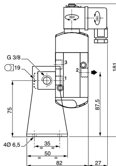
Ce dispositif permet de monter les distributeurs dans 4 positions au choix
