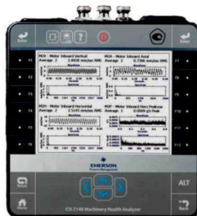
Рисунок 1- Внешний вид анализатора CSI 2140
