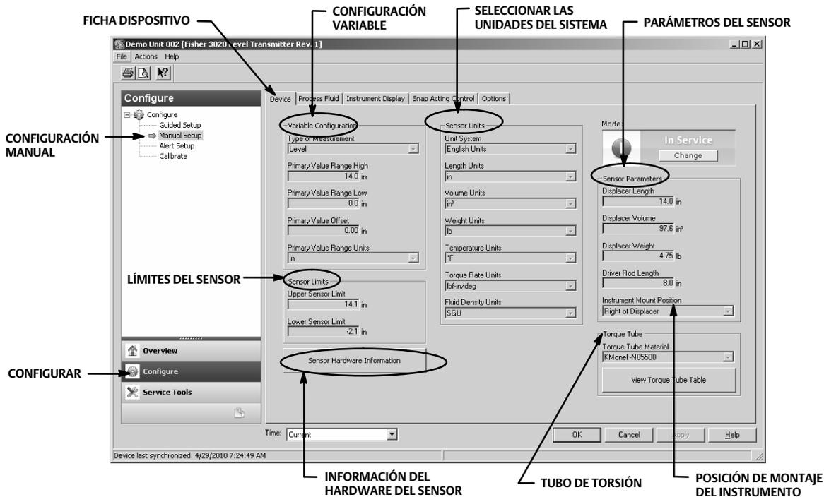
*Primary Value Offset* (Desviación del valor primario) - la desviación constante aplicada a la medición del nivel/interfase.
