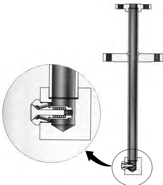
Figura 3. Detalhes do dessuperaquecedor Fisher DMA/AF-HTC
