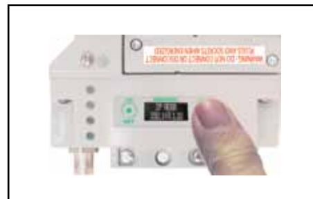
Klartextanzeige für Konfiguration & Diagnose
