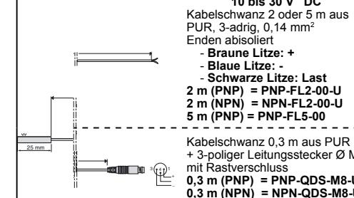
Kabelschwanz 0,3 m aus PUR + 3-poliger Leitungsstecker Ø M12 mit Rastverschluss
