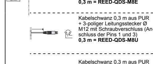
Kabelschwanz 0,3 m aus PUR + 3-poliger Leitungsstecker Ø M12 mit Schraubverschluss
