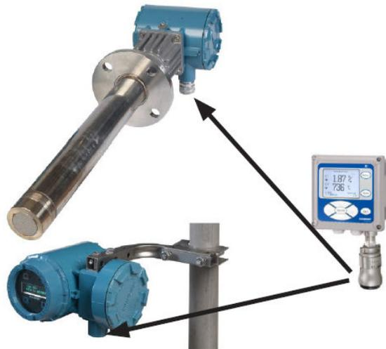
O adaptador Smart Wireless THUM converte o sinal padrão de 4 a 20 mA do Oxymitter ou Xi Electronics em um sinal wireless. Todas as informações do HART® são transmitidas além do valor de O<sub>2</sub> do processo. Somente área segura.
