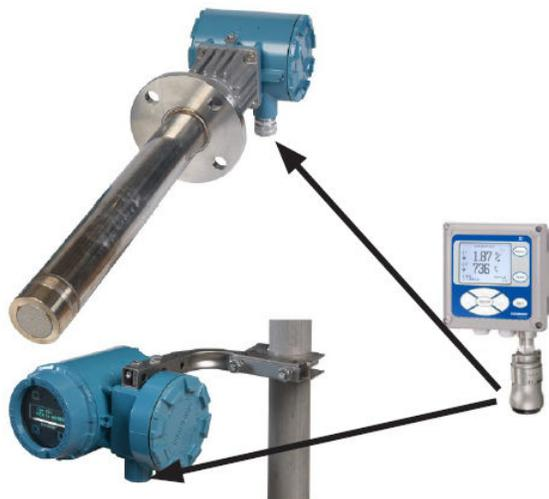
L'adaptateur sans fil Smart THUM convertit le signal standard 4-20 mA de l'Oxymitter ou de l'électronique Xi en un signal sans fil. Toutes les informations HART® sont transmises en plus de la valeur O<sub>2</sub> du procédé. Zone sûre uniquement.
