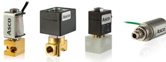
Estas válvulas solenoides Preciflow de 2 vías normalmente cerradas están diseñadas para controlar proporcionalmente el flujo de aire y gases inertes variando la señal de entrada eléctrica a la bobina.
