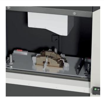
La soldadura simultánea, combinada con la tecnología de servoaccionamiento de la mesa elevadora de la GLX, tiene como resultado un ciclo de soldadura a alta velocidad de entre 0,5 y 5 segundos, dependiendo del material y de la complejidad geométrica de la pieza.
