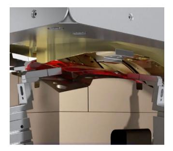
La ausencia de movimiento de las piezas durante la unión permite crear soldaduras más precisas y juntas herméticas, si es necesario.
