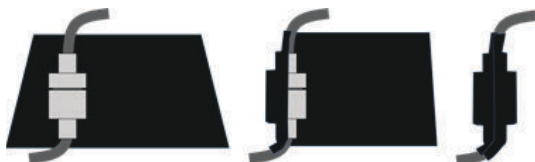
Figura 4-8: Aplicación de sellador coaxial a las conexiones de cable
