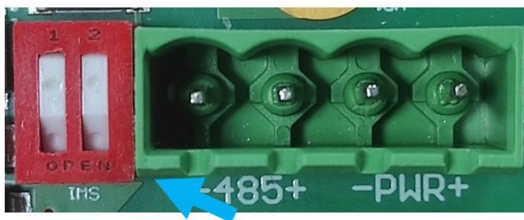
Figura 3-6: Resistencia de terminación RS485
