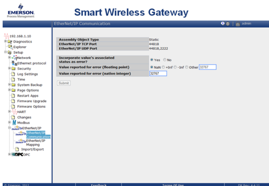
Figura 5-7. Página EtherNet/IP Communications (Comunicaciones EtherNet/IP)
