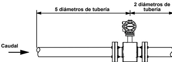
Se pueden realizar instalaciones con tramos rectos de tubería reducidos desde 0 hasta 5 diámetros. En instalaciones en tramos rectos de tubería reducidos, el funcionamiento se desviará. Los caudales transmitidos seguirán siendo muy repetitivos.
