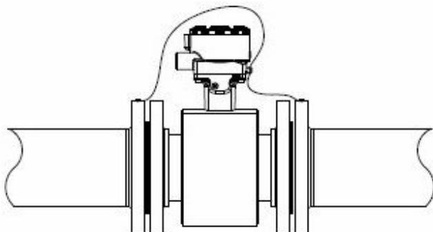
**Figura 5-2: Conexión a tierra con aros de conexión a tierra o protectores de revestimiento en tubería conductora**
