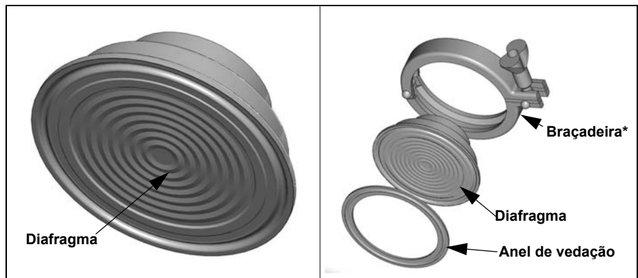
Figura 3-27. Diagrama 3-D do selo remoto higiênico tipo Tri-Clamp
