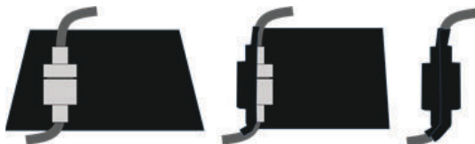
Figura 4-8: Applicazione del sigillante coassiale alle connessioni dei cavi
