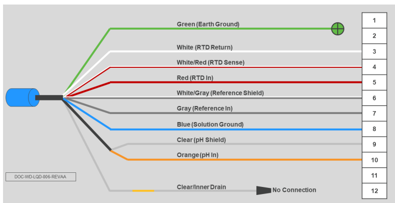
Figura 3-6: Cablaggio del sensore di pH/ORP senza preamplificatore 396P, 396PVP, 396RVP, 3300HTVP, 3400 HTVP, 3500P, 3500VP, 3900 o 3900VP Rosemount al trasmettitore 5081 Rosemount
