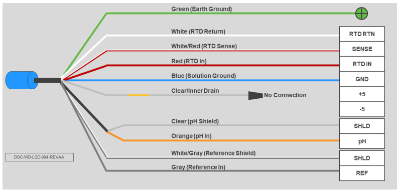
Figura 3-4: Cablaggio del sensore di pH/ORP senza preamplificatore 396P, 396PVP, 396RVP, 3300HTVP, 3400 HTVP, 3500P, 3500VP, 3900 o 3900VP Rosemount al trasmettitore 56, 1056, 1057 o 1058 Rosemount
