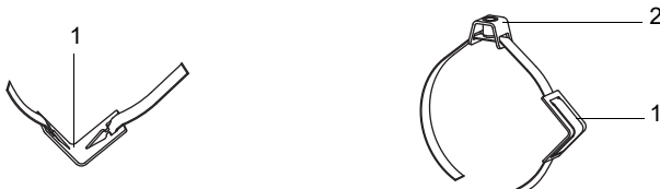
Afb. 6.41: Spanband met metalen veer en spanbandklem
