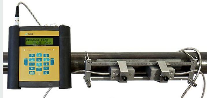
Medición con transmisor de caudal fijado en la tubería mediante el sistema de fijación QuickFix
