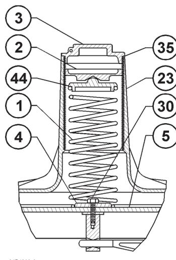
Σχήμα 3. Τύπος Y692 με διάταξη ελατηρίου ελαφρού ελέγχου
