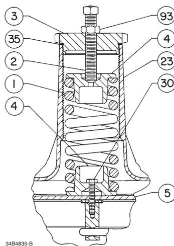
Σχήμα 1. Τύπος Y692 με διάταξη ελατηρίου βαρύ ελέγχου
