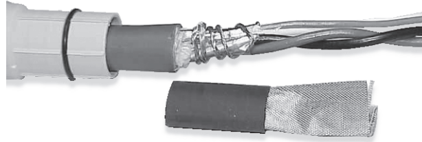
図 3-7: 露出したドレインワイヤを熱収縮シールドチューブで完全に覆う
