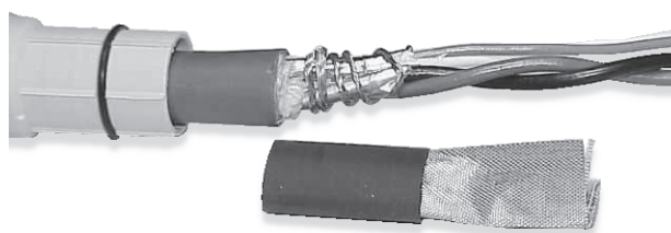
図 3-6: 露出したシールドホイルの周りに 2 回巻き付けたシールドドレインワイヤ
