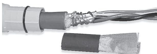
Figur 3-6: Kabelskärmens bildare lindad två varv runt den exponerade skärmfolien
