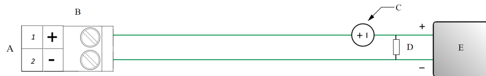
Abbildung 3-13: Verkabelung des Frequenzgangs (mit externer Spannungsversorgung)
