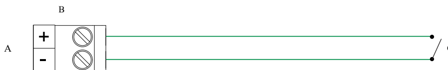
Abbildung 3-20: Verkabelung des Binäreingangs (mit interner Spannungsversorgung)
