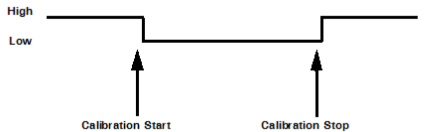
Abbildung 4-13: Gating-Konfigurationsparameter „State gated, active low“
