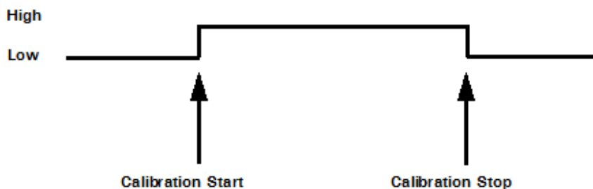
Abbildung 4-12: Gating-Konfigurationsparameter „State gated, active high“
