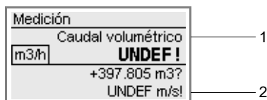
Fig. 13.1: Velocidad de flujo fuera del rango de validez
