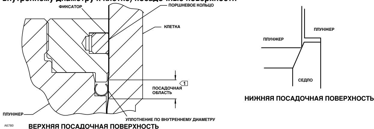
Рис. 11. Нижняя (плунжер клапана к седлу) и верхняя (уплотнение плунжера по внутреннему диаметру к клетке) посадочные поверхности
