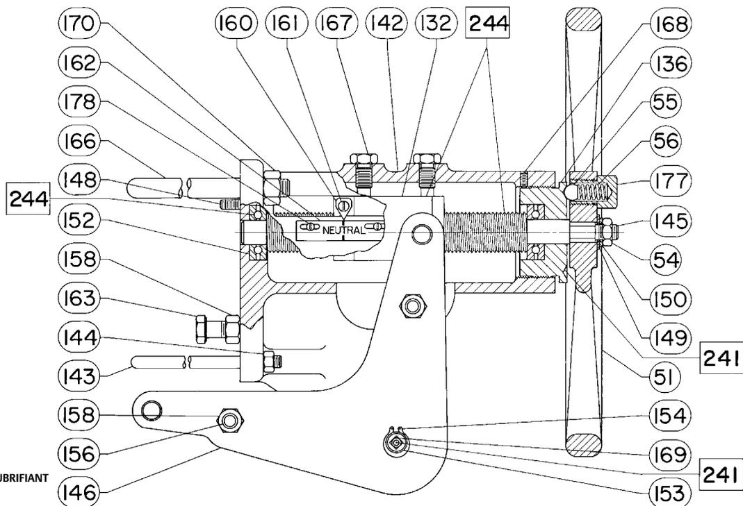
Figure 16. Montage du volant de manœuvre latéral pour les actionneurs de tailles 45i, 46i, 50i et 60i
