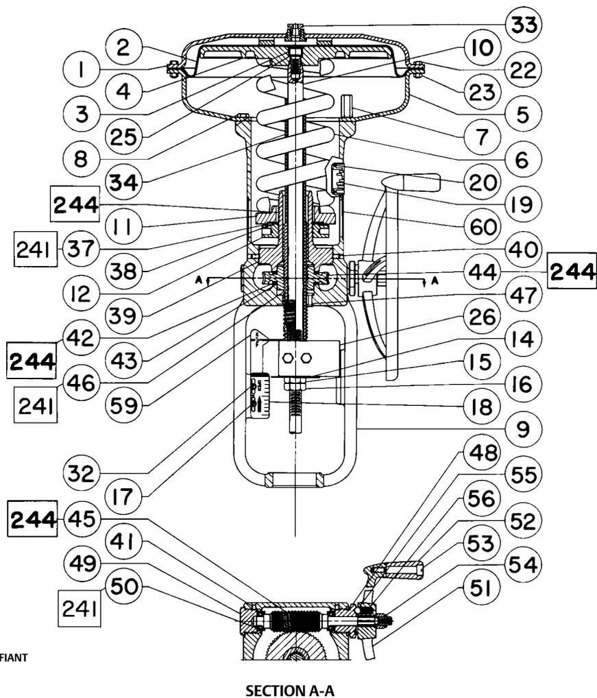
Figure 18. Butée de course ascendante réglable montée sur boîtier pour actionneurs de tailles 30/30i à 60/60i (Style 1)
