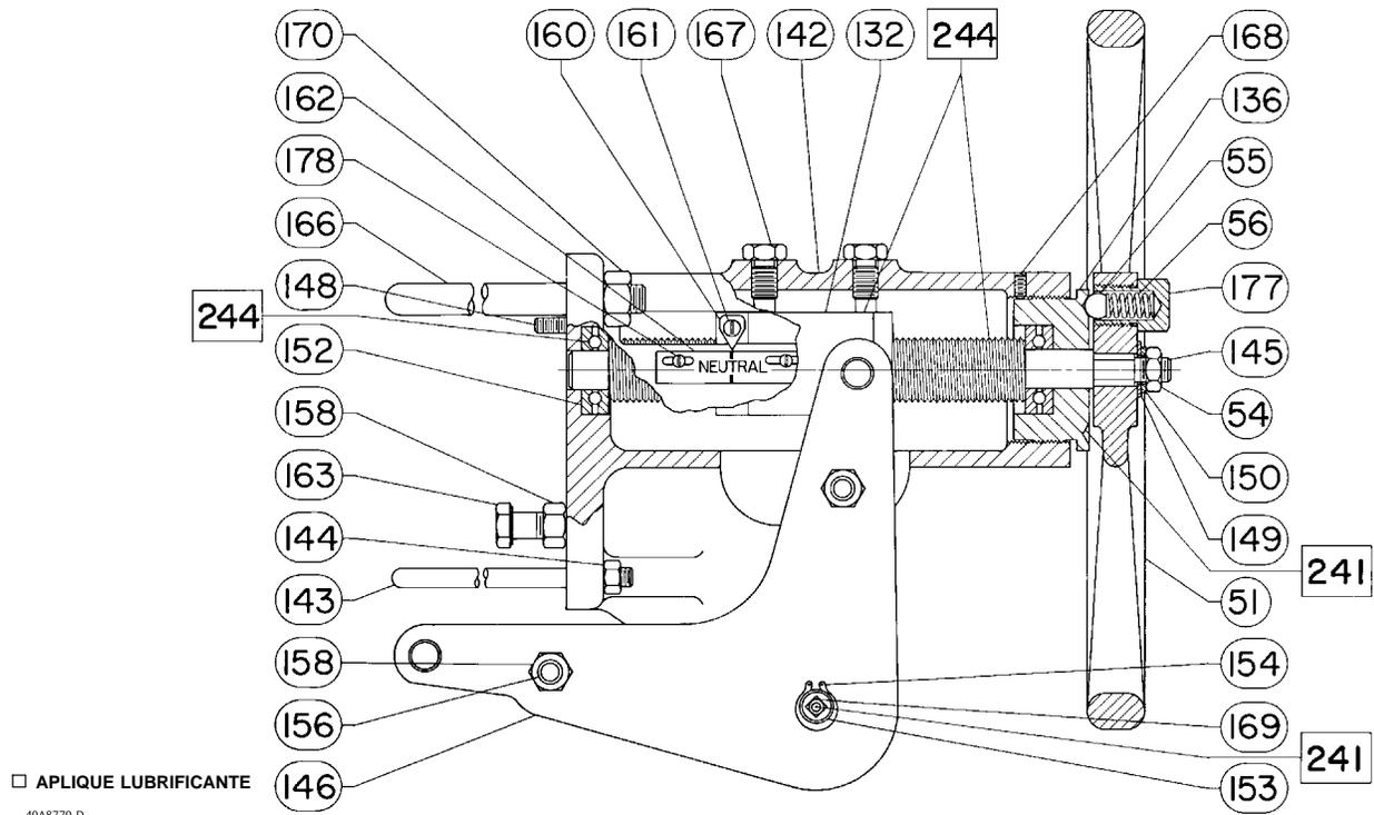
Figura 16. Conjunto de Volante Montado Lateralmente para Actuadores de Tamanhos 45i, 46i, 50i e 60i
