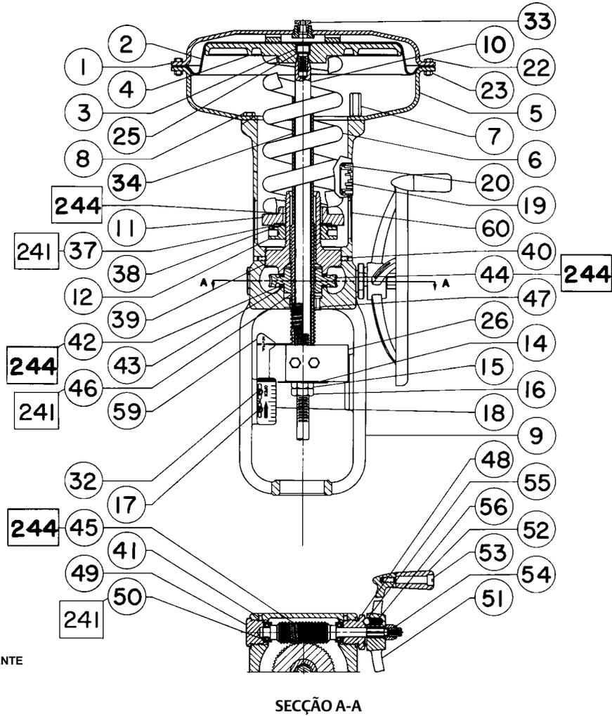
Figura 18. Batente de Deslocamento Ajustável para Cima Montado na Caixa para Actuadores de Tamanhos 30/30i a 60/60i (Estilo 1)
