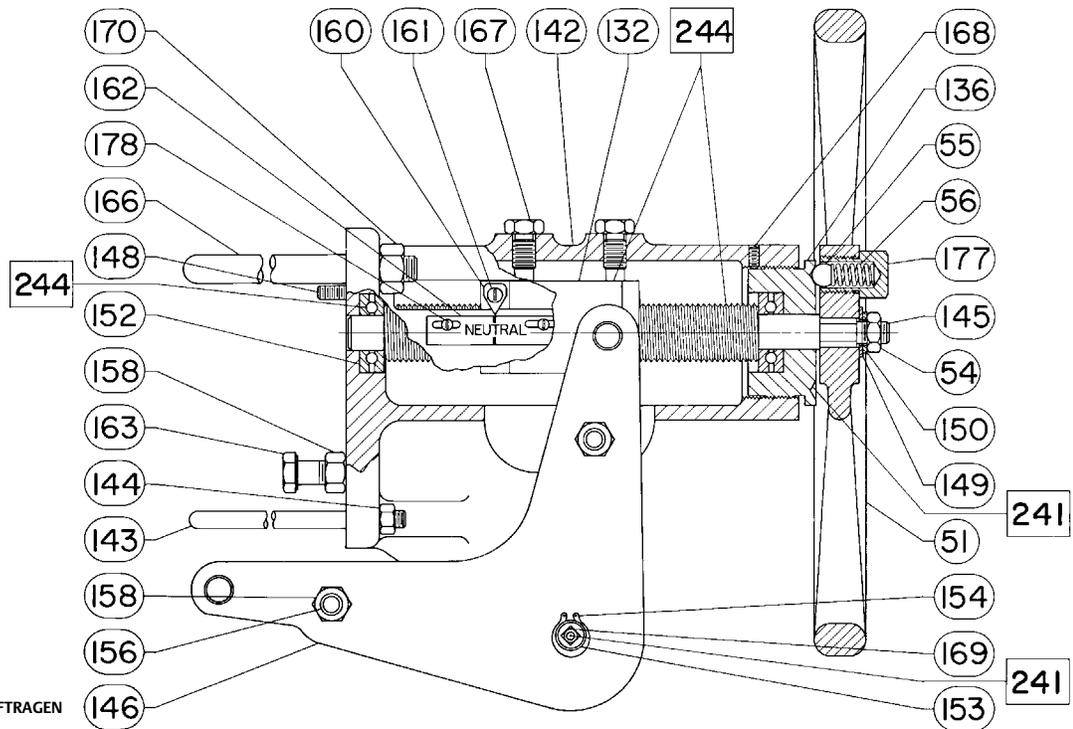
Abbildung 16. Seitlich montiertes Handrad für Antriebe der Größen 45i, 46i, 50i und 60i
