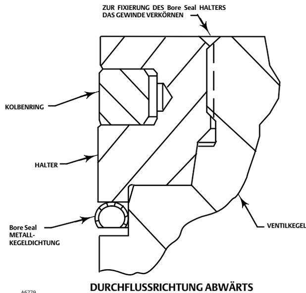
4. Die Bruchstellen zwischen den Teilen des Kolbenrings/der Kolbenringe suchen. Den Kolbenring mit einem geeigneten Werkzeug wie z. B. einem Schraubendreher mit flacher Klinge vorsichtig aus der Nut im Bore Seal Halter heraushebeln.
