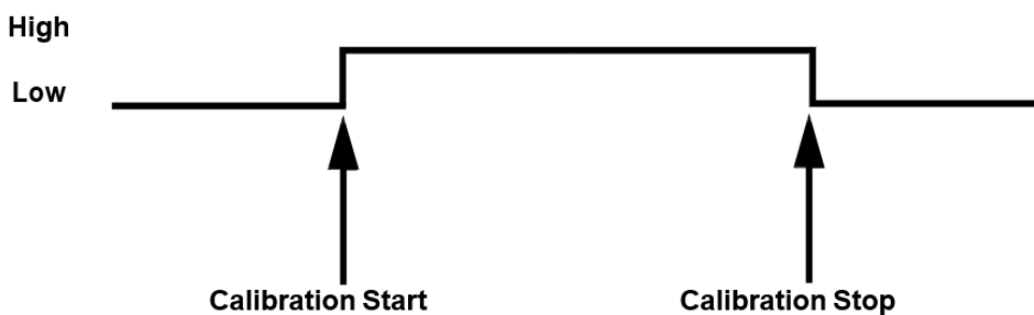
Rysunek 5-8: Bramka stanu parametru konfiguracyjnego bramki, aktywny stan wysoki
