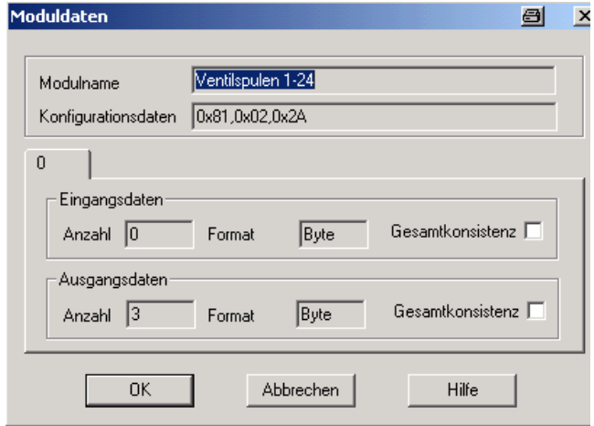
Fig. 17: Fönster moduldata, exempel 24 Ventilspolar
