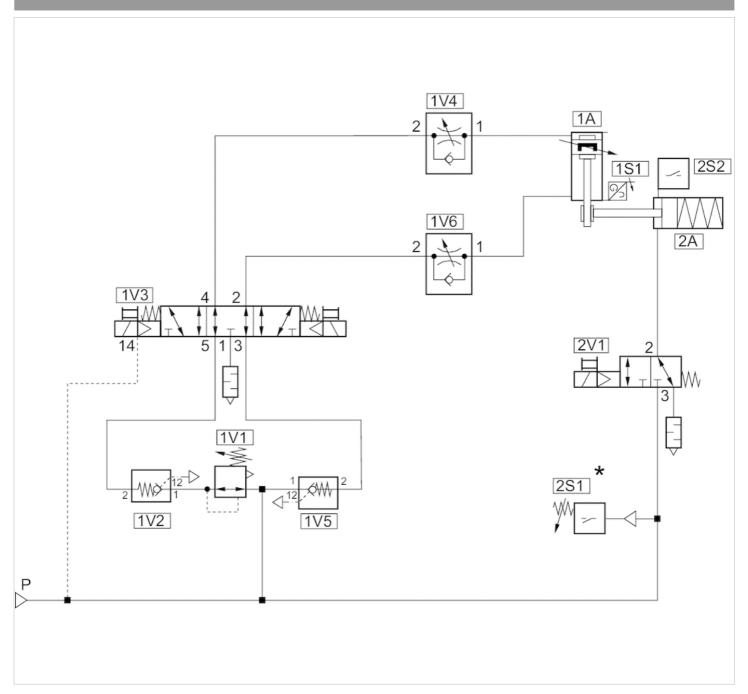
Kanal 1: Sicheres Anhalten und Absperren Kanal 2: Sichere Bremsansteuerung
