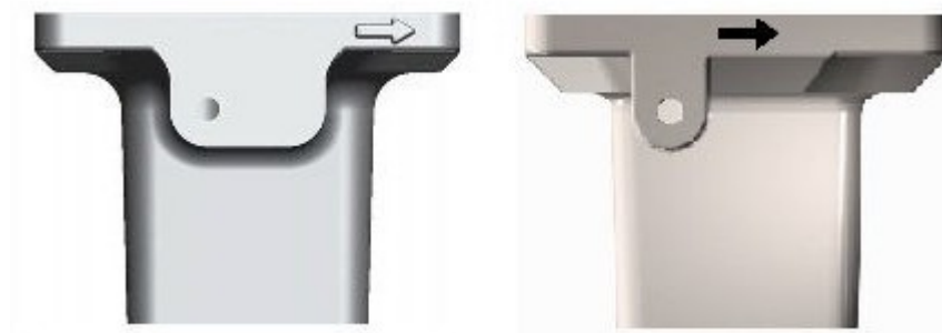
Рисунок 3-2. Стрелка, указывающая направление потока
