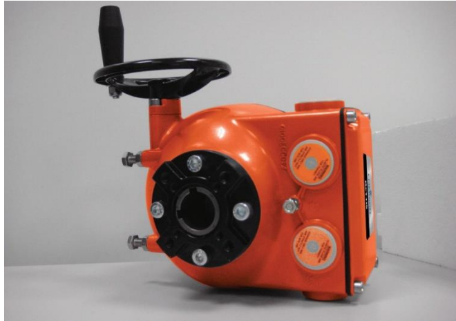
Figura 6 Visão geral da Montagem do flange da válvula
