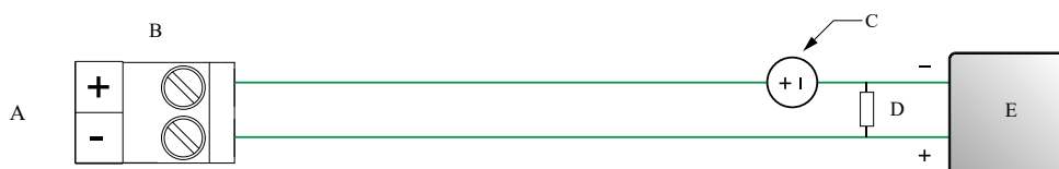
Figura 3-10: Fiação de saída discreta (alimentada externamente)
