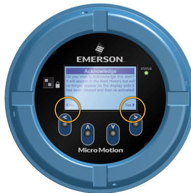
Figura 8-3: Exemplo 2: indicadores de seta ativos no display do transmissor
