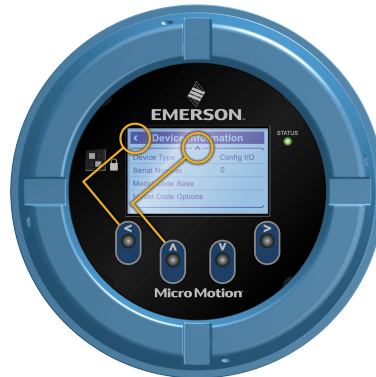
Figura 8-2: Exemplo 1: Ative os indicadores de seta no display do transmissor
