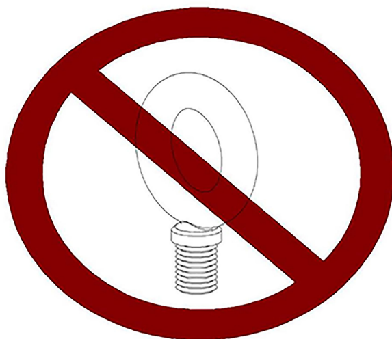
Figura 2-27: Olhal fora de conformidade
