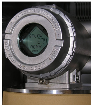
Figura 1-5: Invólucro com componentes eletrônicos do transmissor, display local e tampa de vidro
