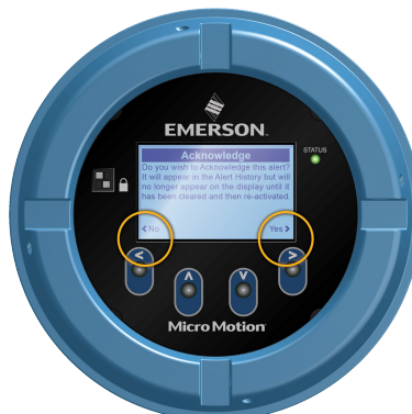
図 8-3: 例 2: トランスミッタディスプレイ上の矢印インジケータを作動させる
