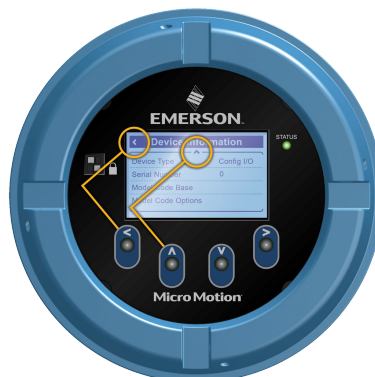
図 8-2: 例 1: トランスミッタディスプレイ上の矢印インジケータを作動させる
